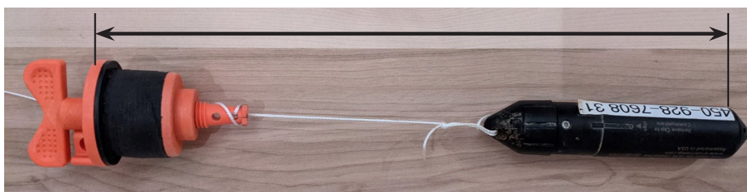
Figure 3. Mesure de la longueur entre le bouchon du piézomètre et le capteur de pression de la sonde
